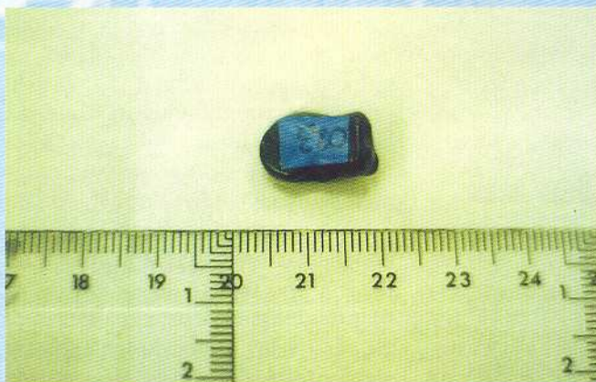
Transmisor SS-2 (Biotrack) con pila de 1,4 v y una duración de 90 días.
